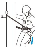
(注)伸縮調節器は作業時に加わる体重で内部の押爪がロープを噛み、任意の位置で停止します。
