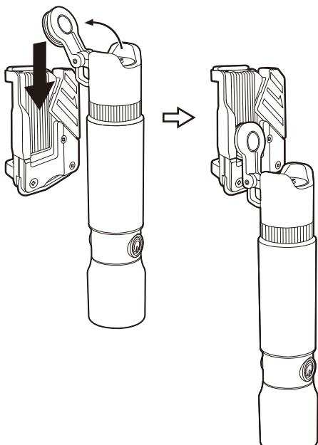
可動式セフフックを起こしてから、セフホルダーに「カチッ」と音がするまでしっかりと差込み固定します。
