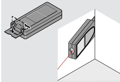
**i** エンドピースは自動検知され、測定基準のゼロポイントが決定されます。
