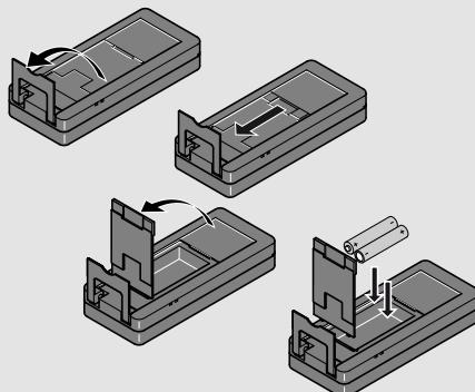
製品スペック確保のため、マンガン電池を使用しないでください。電池残量のアイコンが点滅した時には、電池交換して下さい。
