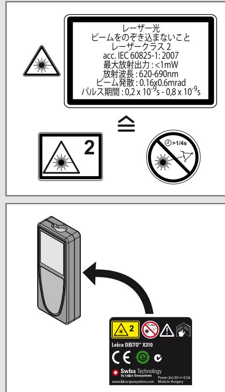
日本測量機器工業会発行「測量機器の安全確保のための表示に関するガイドライン」(第三版)に基く表示
