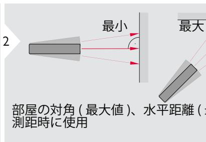
最小値、最大値(min. max.)が表示され、最後の測定結果がメイン行に表示されます。
