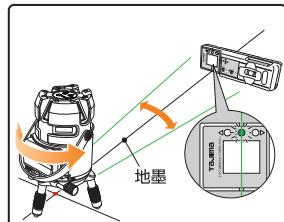
※本体を回転させてレーザー縦ラインが地墨線上に来ると受光器のグリーンLEDが点灯します。
