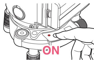
電池残量が無くなると、受光器の操作に反応しなくなり、スイッチ部LEDが点滅します。60秒点滅後自動的にOFFになります。この場合、電池寿命ですのでアルカリ乾電池2本を同時に交換してください。
