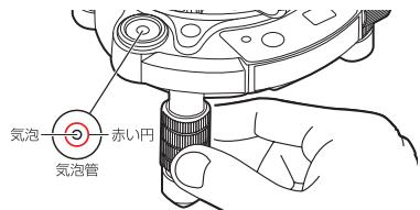
本体が±2°以上傾いている場合は、補正範囲外のためレーザーは自動的に消灯し、制御ランプ(緑)が早く点滅します。
