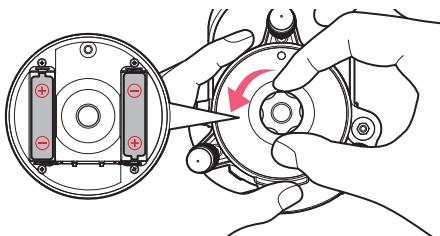
取付時は本体と電池フタの間に隙間ができないように外周部をしっかりと押さえて電池フタ止めネジを締めてください。
