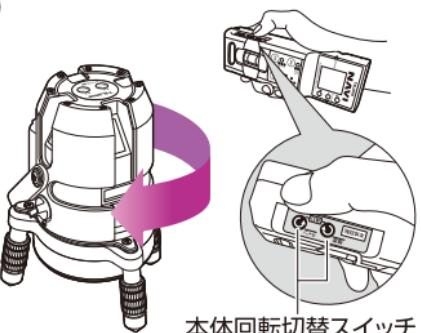
4 レーザーラインが使用したい位置に来たら、もう一度本体回転切替スイッチを押す。墨出し器本体の回転が止まります。
