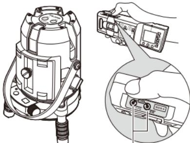
3 受光器を図のように墨出し器本体に向け、本体回転切替スイッチを押す。墨出し器本体が回転します。
