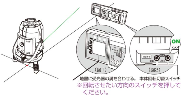
**5** レーザーラインが受光窓に入ると接近LED（赤もしくはオレンジ）が点灯し、自動的に微調整を開始します。
