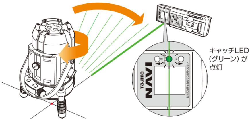
**6** 墨出し器の回転が止まり、キャッチLED（グリーン）が継続して点灯することが確認できたらナビ動作完了です。
