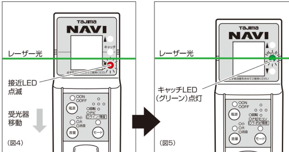
**6** その位置で受光器上の気泡管で水平を確認し、受光器が動かないようにしつかりと固定し、墨書きを行なってください。
