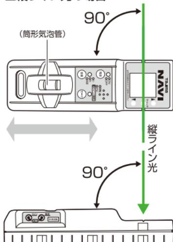
**5** 受光窓で、レーザー光を受けると接近LED（赤もしくはオレンジ）が点滅します。（図4）点滅している側の接近LED側にゆっくりと受光器を動かしていくと、キャッチLED（グリーン）が点灯し、連続ブザー音が鳴ります。その位置がレーザー光の中心位置です。（図5）
