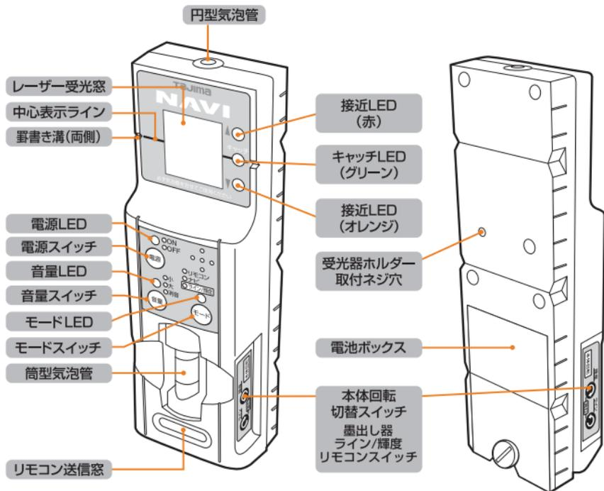
■表示LEDの色とブザー音によりレーザーラインが中心表示位置のどちら側にあるか判別できます。
