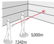
② ON／測定キーをもう一度押すと、最後の測定値がメインディスプレイに表示されます。
